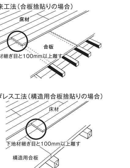
●合板の含水率1%当たりの寸法変化率は0.02%程度です。広い部屋や長い廊下に施工する場合は突き上げることがあります。縫継ぎは5枚が限度です。突き上げや目スキを予防するためには「見切り」などの処置をしてください。
