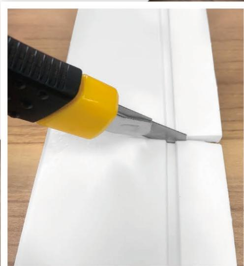
電動ノコギリなどを用いず、カッターやハサミで切断可能。(切粉なども減らせます)
